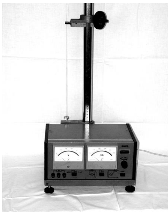
Рис. 9.1. Установка для измерения удельного сопротивления тонкого провода
